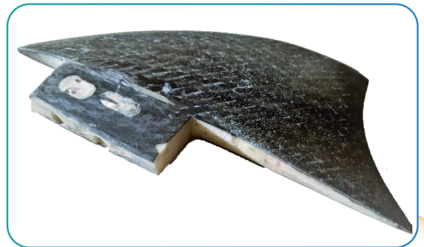
Aileron de surf imprimé en PVC drapé carbone époxy avec inclusion d'écrous inox
