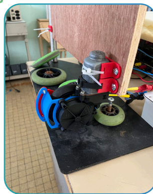
Mini projet Énergies et Environnement (EE) : Ouvre-portail motorisé fabriqué avec un moteur lève-vitre électrique de voiture.
